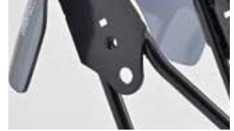
カスタムウインカーなどの装着に使えるφ8サービスホール。
