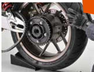
スローブを転がしてホイールを脱着できます。
